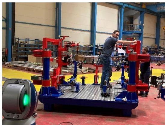
Slika 3: Laserske meritve vpenjalne priprave za varjenje [14]
