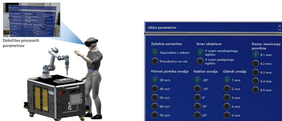
Slika 2: Nastavitev tehnoloških parametrov preko hologramskega vmesnika in izbira tehnoloških parametrov robotske naloge
