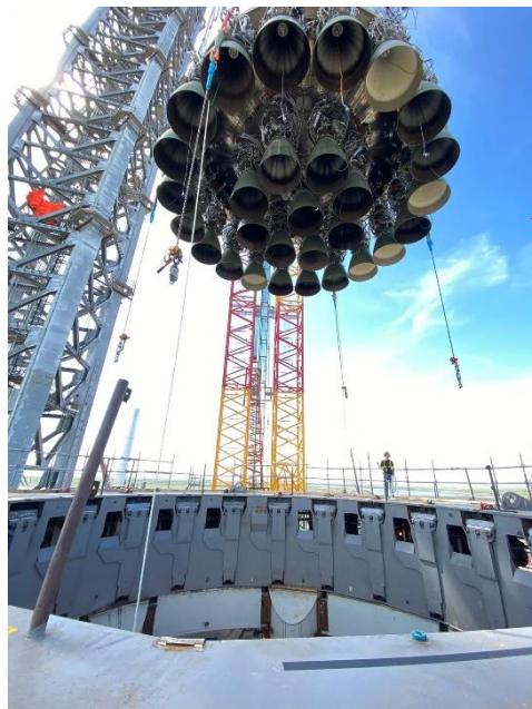
Nameščanje motorjev Super Heavy Heavy (SPACE, 2021 8 )
