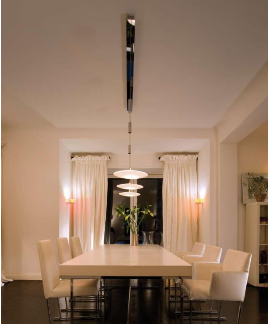
Slika 6: Razsvetljava jedilnice s spuščnimi svetilkami, direktna komponenta svetlobe na jedilno mizo in difuzna navzgor z dodatno razsvetljavo ozadja [7].
