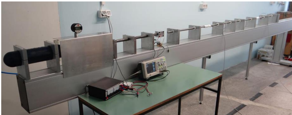
Slika 2: SHPB preizkuševališče na Fakulteti za Strojništvo Univerze v Mariboru [4].
